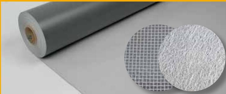
Die Sikaplan® U ist eine Kunststoffabdichtungsbahn mit einer Verstärkung aus Glasvlies und Polyesterlegele. Sie ist ideal geeignet für den Einsatz auf frei bewitterten Dächern und für die Anwendung unter Auflast.
