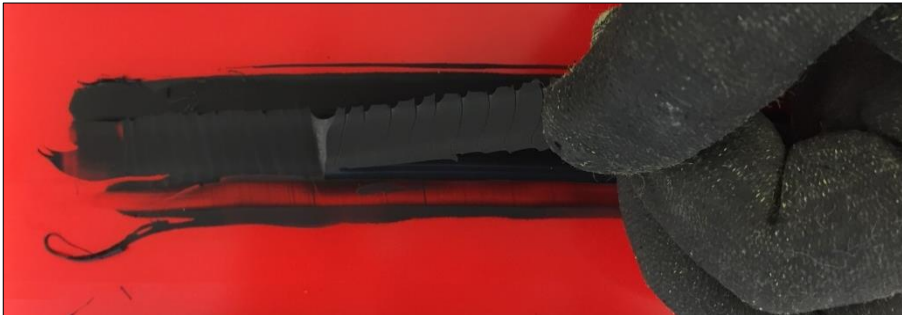
BILD 24 Raupenschältest: Ziehen der Raupe vom Untergrund, 100 % kohäsives Bruchbild
