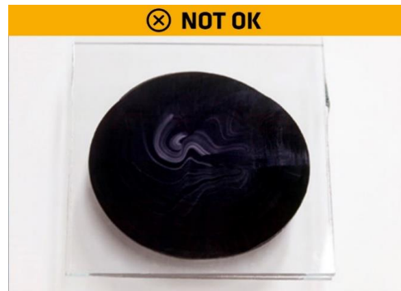
BILD 8 Negativer Test = unzureichende Mischung
