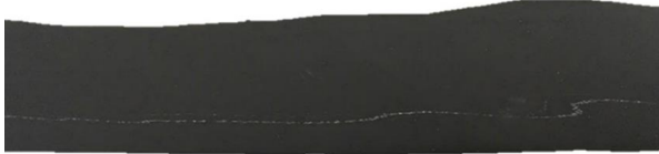
BILD 15 Weiße Streifen im Material, inhomogene Mischung
