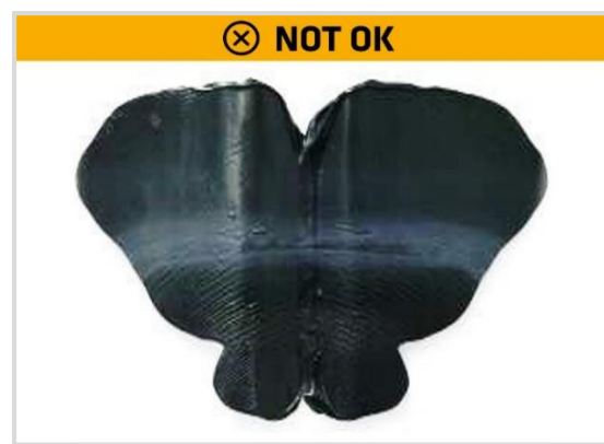
BILD 12 Folie auffalten - Negativer Test = unzureichende Mischung
