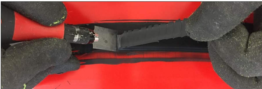
BILD 25 Raupenschältest auf emailliertem Glas: Raupe wird unter Spannung eingeschnitten
