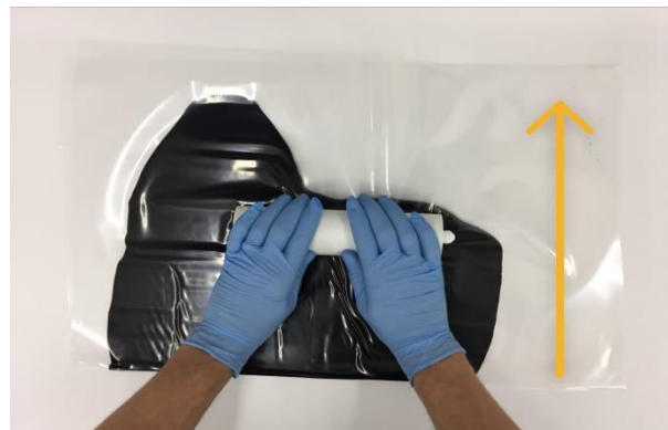
BILD 10 Die Klebstoffraupe nur rechtwinklig zum Falz beaufschlagen
