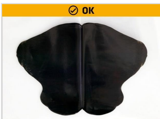
BILD 11 Folie auffalten - Positiver Test = ideale Mischung
